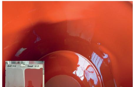
Tapox unvollständig mit Härter gemischt, deutliches Abfließen, Bild links.
