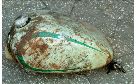
Helaas hebben we Bij historische voertuigen nog wel eens te maken met in- en uitwendige roest waardoor er zelfs wel eens sprake kan zijn van brandstof lekkage. Tapox is zeer goed bestand tegen brandstof maar is niet ontworpen om lekkende tanks te dichtten. Dus voordat Tapox wordt gebruikt test de tank op lekkage in geval van lekkage repareer dit eerst bijv. met Quiksteel Metal Tank reparatie set of een ander degelijk product. Hierna kan Tapox toegepast worden voor een langdurige bescherming.
