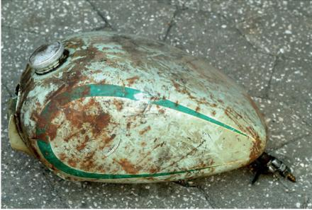
Malheureusement, il arrive que le réservoir de carburant des véhicules de collection n'a pas seulement de la rouille dans le réservoir mais qu'il a déjà des perforations qui occasionnent des pertes de carburant.
