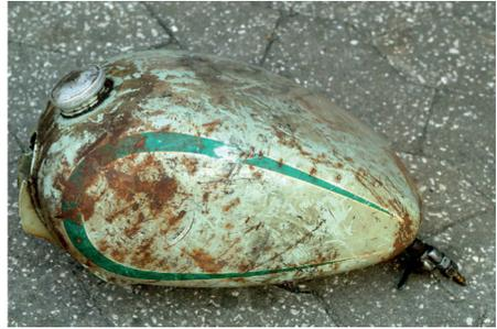
Niestety wewnątrz starych zbiorników paliwa można znaleźć nie tylko rdzę, lecz również perforacje powstałe na skutek długotrwałego procesu korozyjnego. Skutkiem tych nieszczelności są wycieki paliwa. TAPOX 2-K jest całkowicie odporny na każdego rodzaju paliwa, ale w swej cienkiej warstwie może nie zamknąć nieszczelności zbiornika. W takiej sytuacji należy dokonać odpowiedniej naprawy blacharskiej, a następnie zastosować TAPOX 2-K, celem długoterminowej ochrony wnętrza zbiornika.
