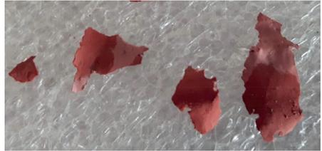
Vous pouvez constater sur la photo le dégât causé par un mauvais mélange de 2-K après application. Il est clair que l'on voit les emplacements rouges foncés qui ne durcissent pas correctement et ne peuvent adhérer totalement parce qu'il n'y a pas de mélange avec le durcisseur (composant 1) et la base (composant 2)
